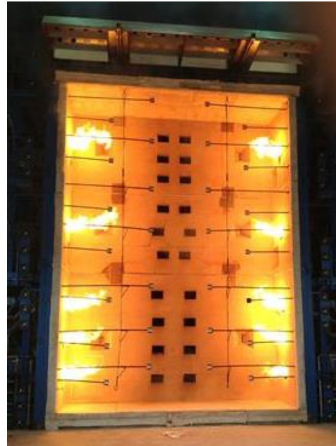
5 m x 7 m κλίβανος με θύρες καυστήρα σε λειτουργία
