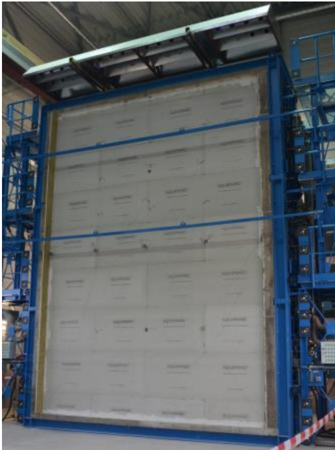
5 m x 7 m κλίβανος με εγκατεστημένο δοκίμιο
